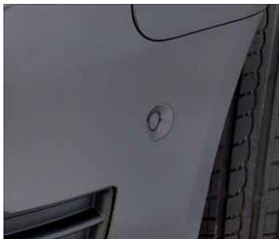
Место установки бокового левого ультразвукового датчика парковочного автопилота
