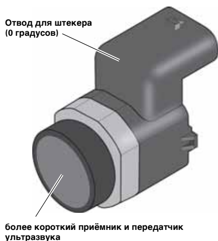
Ультразвуковой датчик акустического парковочного ассистента
